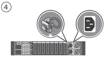
4. 시스템을電源に接続し、電源ケーブルを固定します。 전원 소스에 시스템을 연결하고 전원 케이블을 고정시킵니다.
