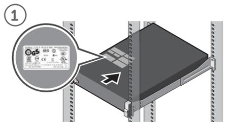
1. 엔크ローージャ를 랙에取り付け、システム上部のシステム電氣定格情報を確認します。 랙에 인클로저를 설치하고 시스템 상단의 시스템 전자 등급 정보를 읽어 보십시오.
