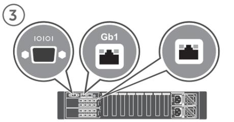
3 Connect the CMC and I/O modules. 连接 CMC 和 I/O 模块。 Sambungkan CMC dan modul I/O.
